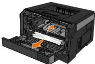
4. Установите картридж с тонером на место, совместив круглые белые штифты на картридже с белыми стрелками на канавках фотобарабана и нажмите на картридж до упора. При правильной установке картридж защелкивается в фиксаторах.
