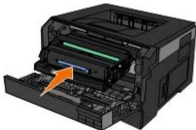
9. После замены фотобарабана необходимо сбросить счетчик фотобарабана. Чтобы обнулить счетчик, см. инструкцию к новому фотобарабану.
